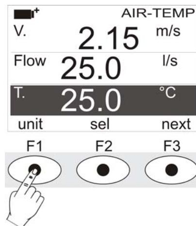
Presser la touche **fonction F3** quand mot **next** apparaît sur la dernière ligne de l'écran pour passer à l'affichage des mesures relevées par sonde **de lumière** pourvue de module SICRAM, avec l'affichage suivant:
