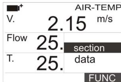
Avec les touches de navigation ▲ ▼ sélectionner **section** et presser **Enter**. L'écran suivant apparaît
