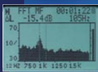
► Analyse spectrale par bande fine (option FFT)
