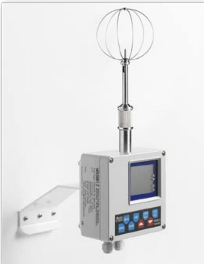
HD2001.2: Température, humidité, pression, vitesse de l'aire, sortie RS232 / RS485.
