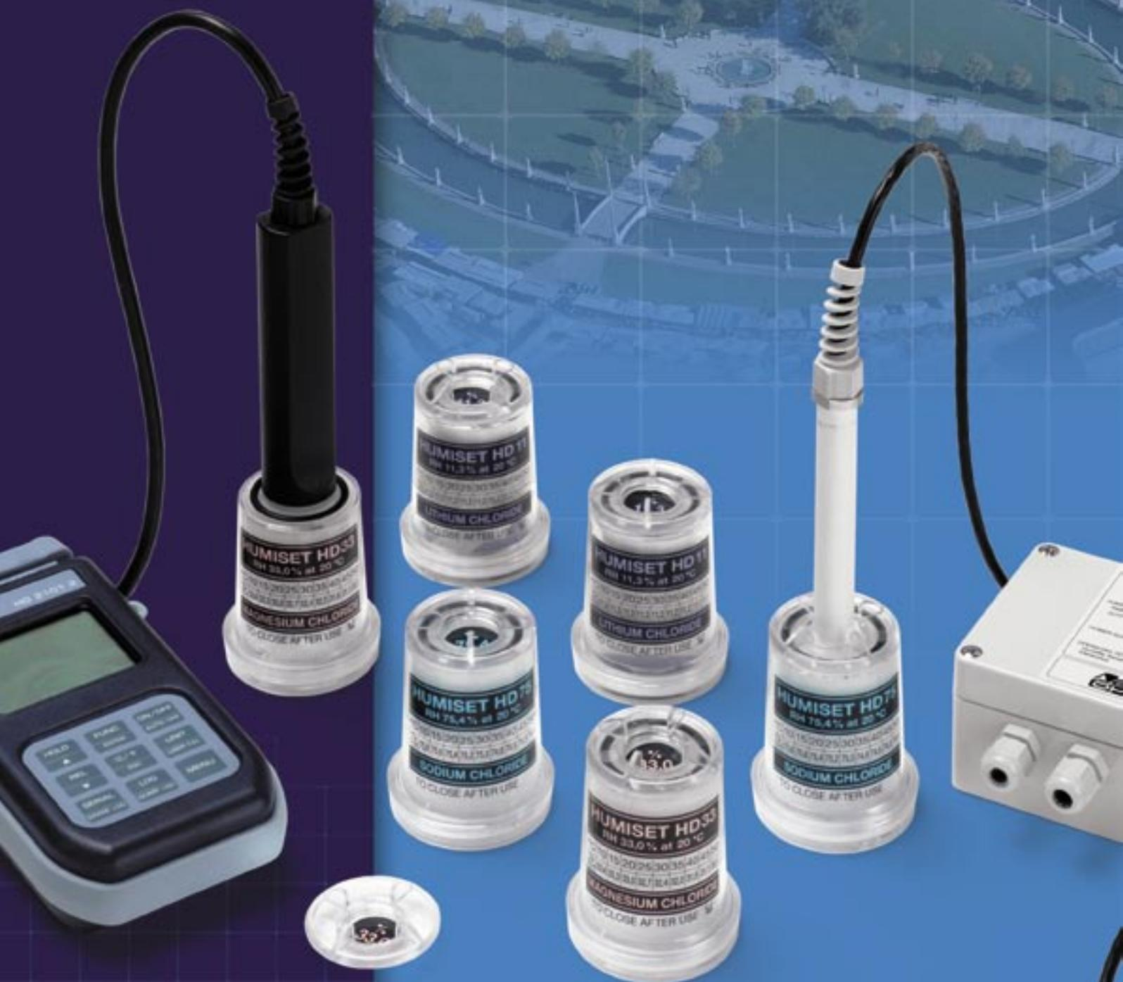
*Usage des solutions salines saturées pour le contrôle, la mise au point ou l'étalonnage des instruments avec capteurs d'Humidité Relative.*
