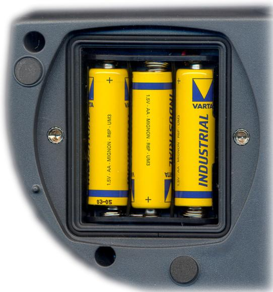
**Après le changement de piles, il faut régler de nouveau** la date, l'heure, le baud rate. Pour passer d'une rubrique à la suivante appuyer sur la touche ENTER; pour revenir en mesure, appuyer sur MENU.
