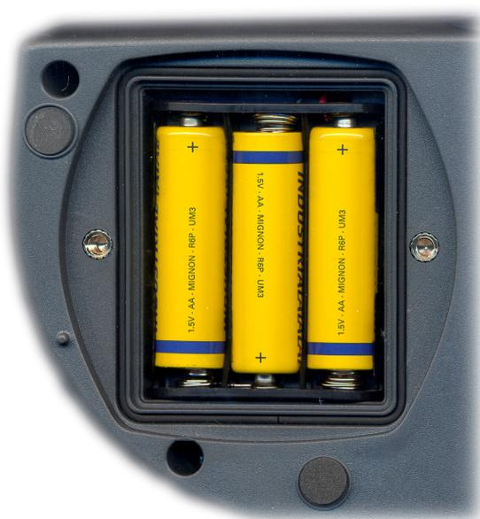
**Après le changement de piles, il faut régler de nouveau** la date, l'heure, le baud rate. Pour passer d'une rubrique à la suivante appuyer sur la touche ENTER; pour revenir en mesure, appuyer sur MENU.
