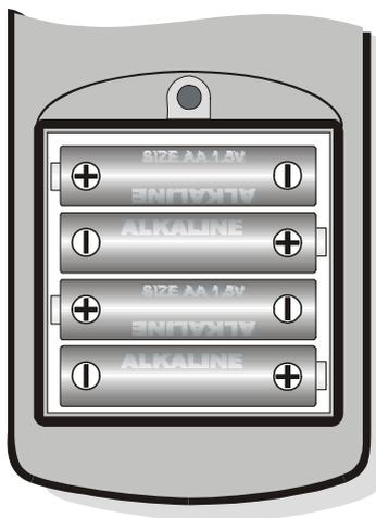
**Après le changement de piles, il faut régler de nouveau** la date, l'heure, le baud rate, le type de sonde, l'intervalle d'impression, les paramètres de logging: **pour simplifier l'opération, lors de l'insertion des nouvelles piles, l'instrument s'allume automatiquement et demande par la suite tous ces paramètres.** Pour passer d'une rubrique à la suivante appuyer sur la touche ENTER; pour revenir en mesure, appuyer sur MENU.
