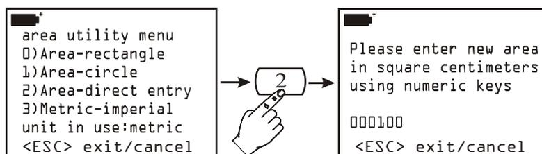
Entrer la mesure de la surface à l'aide des touches numériques; **la valeur de la surface doit être comprise entre 100 et 100000  $\text{cm}^2$  c'est à dire entre 0.01 et 10  $\text{m}^2$ . Si la valeur de la surface n'est pas comprise dans les limites indiquées, l'instrument signalera l'erreur et réglera la valeur par défaut sur 100  $\text{cm}^2$ .**
