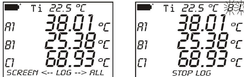
Tant que la fonction d'enregistrement est active, les indications **B et L** ou bien **L** seulement si l'instrument utilise l'alimentation extérieure clignoteront sur l'afficheur.
