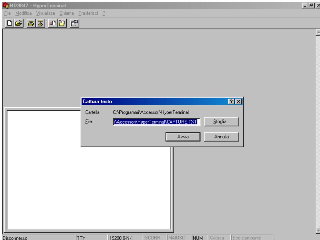
Maintenant, le logiciel HyperTerminal est à même de recevoir les données provenant de l'instrument de mesure et de les enregistrer dans le fichier prédisposé à cet effet.
