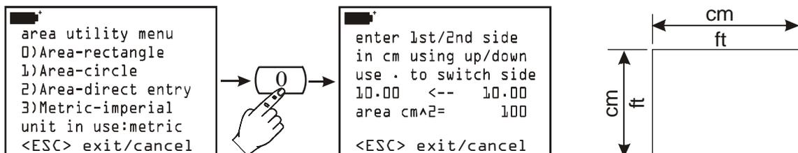
Pour accéder au sous-menu, appuyer sur la touche <0>: les flèches permettent d'augmenter ou de diminuer la mesure du premier côté (**en cm ou en pied**). A l'aide de la touche "." (point décimal) il est possible de sélectionner le second côté et de régler la longueur à l'aide des flèches. Lorsque la longueur des deux côtés varie, l'instrument propose la mesure de la surface
