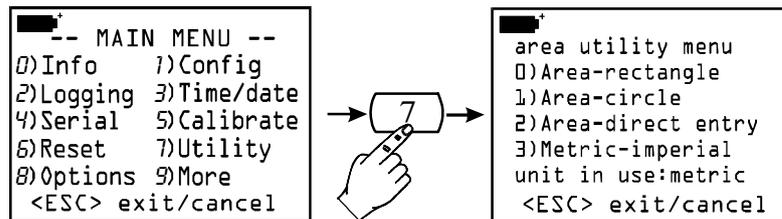
En fonction de la forme géométrique de la surface des prises d'air ou des bouches, il faudra sélectionner la rubrique correspondante du menu:
