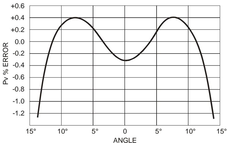
L'angle de rotation autour de l'axe vertical par rapport à la direction du flux (embarquée) est reporté en abscisse, tandis que l'erreur en % sur la mesure de la pression différentielle  $P_v$  est indiquée en ordonnée. Comme on peut le voir, une différence de plus de  $10^\circ$  entraîne une erreur inférieure à 0.5% dans la mesure de la pression différentielle.
