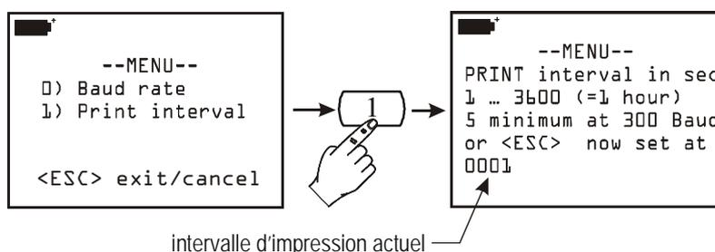
Ce paramètre agit sur les fonctions d'impression immédiate des données: *Screen*, *RCD+* et *ALL* (voir les fonctions "Screen", "RCD+" et "ALL" à partir de la page 93)
