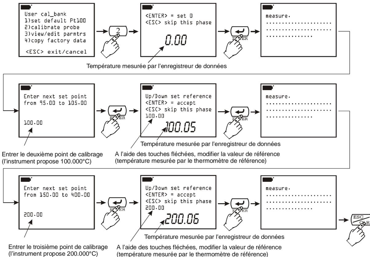
**Calibrage de 0°C:** insérer la sonde dans un bain à 0°C. L'afficheur de l'instrument visualise le degré de température qu'il est en train de lire: lorsque la lecture s'est stabilisée, appuyer sur <ENTER> pour valider le point à 0°C se référant à la sonde échantillon de référence. Appuyer sur <ESC> pour passer au second point sans exécuter le premier point à 0°C.
