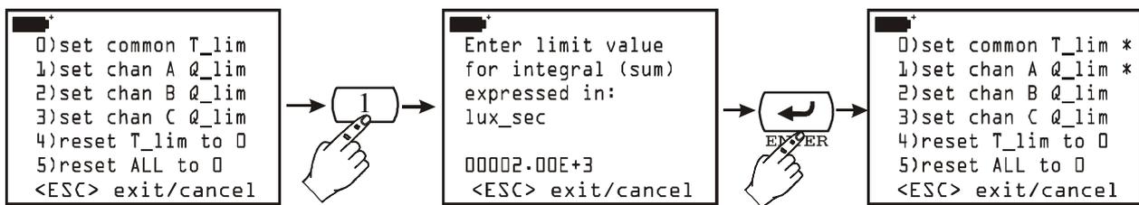
Pour annuler la valeur du temps limite réglée précédemment utiliser la commande "4) reset T\_lim to 0" en appuyant sur la touche <4>. Pour tout remettre à zéro, utiliser la commande "5) reset ALL to 0" en appuyant sur la touche <5>.
