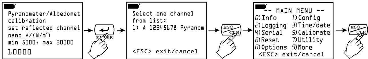
Entrer le deuxième paramètre ou laisser la valeur par défaut égale à 10000 si vous n'utilisez pas la seconde entrée du module; appuyer sur <ENTER> pour valider et <ESC/CLR> deux fois pour revenir en mesure normale. Maintenant, l'instrument fournit les indications des sorties du pyranomètre en tension (mV) ou en rayonnement global (W/m<sup>2</sup>).
