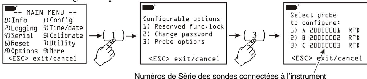
Si la sonde ne contient que les données de calibrage en usine (indiquées par le code «0 factory»), l'instrument utilisera ces paramètres.
