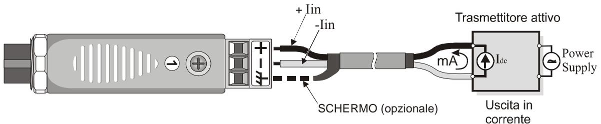
Branchements du module IP472 à un transmetteur actif avec sortie en courant.
