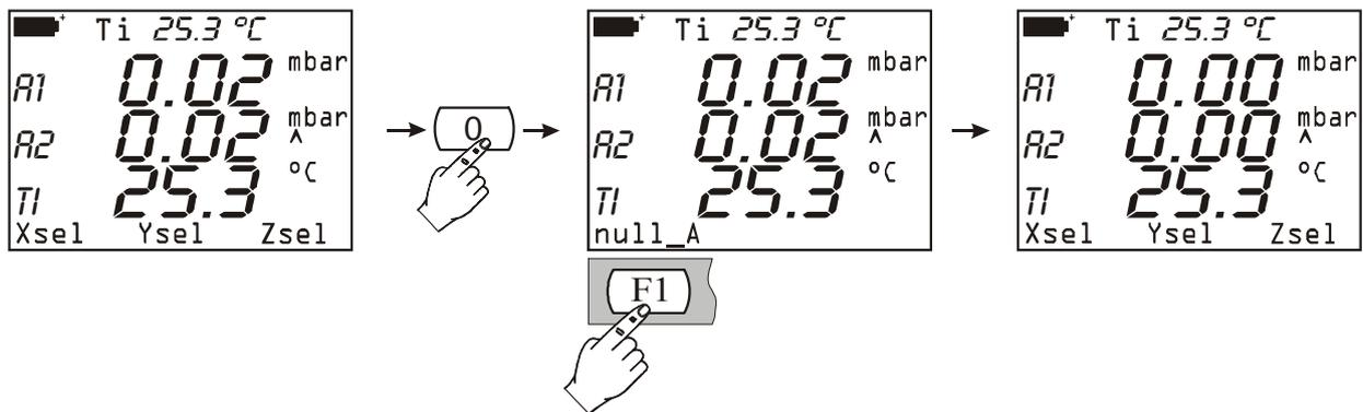
Dans la barre de commandes apparaît le message null\_A, null\_B ou null\_C selon l'entrée où le module est branché. Appuyer sur la touche fonction correspondant à l'entrée pour mettre à zéro la pression différentielle : la valeur instantanée et la valeur du pic correspondante sont mis à zéro.
