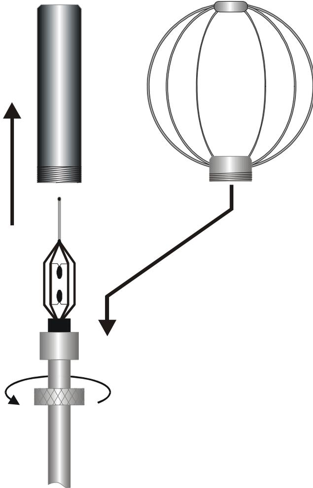
Placer la tête de la sonde dans le flux d'air à mesurer et appuyer sur la touche de remise à zéro <0>. Dans la barre de commandes les messages null\_A, null\_B ou null\_C, en fonction de l'entrée à laquelle le module est connecté, apparaîtront. Appuyer sur la touche fonction correspondante pour remettre à zéro la mesure: toute erreur éventuelle (dérives) sur les valeurs instantanées de la vitesse et du débit sera annulée.
