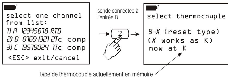
Avant d'insérer un nouveau type de thermocouple, il est nécessaire d'effacer au préalable celui déjà présent dans la mémoire. Dans l'exemple reporté ci-dessus, la sonde est de type K. Appuyer sur la touche <ENTER> pour valider ou sur la touche <9/UNIT> pour modifier. En appuyant sur <9/UNIT>, les données de calibrage du thermocouple reviennent à la valeur par défaut.
