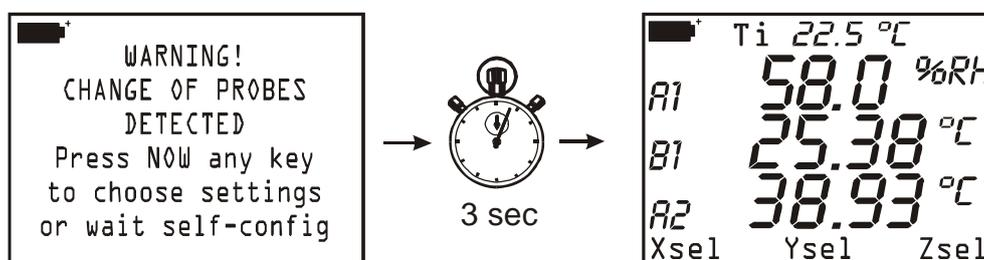
Si, par exemple, à l'entrée A est branché un module pour la mesure accouplée d'humidité et température et à l'entrée B un module Pt100, la configuration automatique s'afficherait à l'écran avec l'ordre suivant : première ligne %RH (A1), deuxième ligne température de la sonde Pt100 (B1), troisième ligne température de la sonde accouplée (A2). En l'absence de modules connectés aux entrées, c'est la mesure de la température interne Ti qui est fournie.
