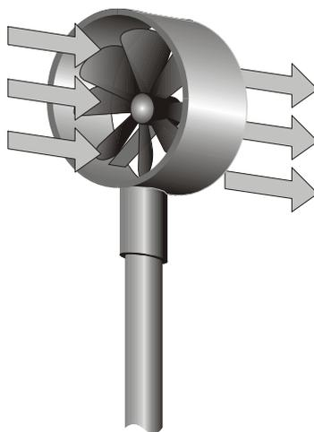
La sonde doit être maintenue perpendiculaire et ne doit pas être inclinée par rapport au flux:
