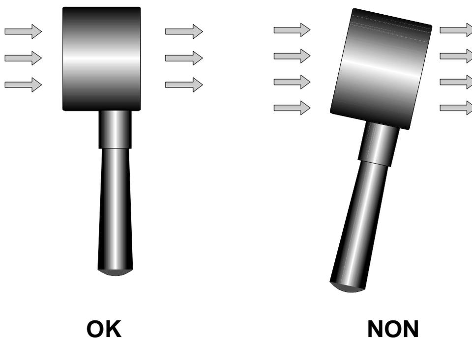
La sonde est installée correctement dans le flux d'air lorsque la valeur relevée est au maximum. Procéder avec le mesurage en suivant les indications fournies dans les premiers paragraphes de ce chapitre.
