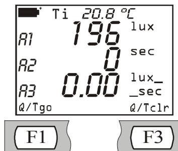
Si une seule sonde est connectée à l'entrée A de l'appareil multifonction, l'affichage initial correspondra à celui reporté ci-dessus. A1 représente la valeur courante fournie par la sonde, A2 indique le temps d'intégration et A3 la valeur de l'intégrale calculée sur la variable A1. Appuyer sur <F3>.
