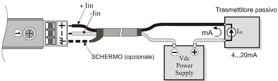
Branchements du module IP472 à un transmetteur passif avec sortie en courant  $4 \dots 20\text{mA}$ .
