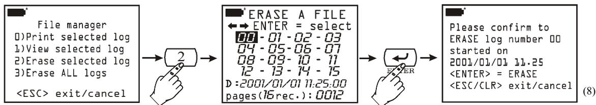
Cette fonction permet d'ouvrir le menu d'effacement de chaque fichier sélectionné. À l'aide des touches fléchées, sélectionner un fichier de données puis, pour l'effacer, appuyer sur <ENTER>. Un message de validation apparaît: appuyer à nouveau sur <ENTER> pour procéder à l'annulation, appuyer sur <ESC/CLR> pour annuler l'opération et revenir au File Manager.
