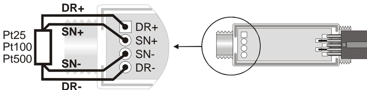
Avant d'effectuer les soudures faire passer le câble de la sonde à travers la gaine et le bouchon en caoutchouc. Veillez à ce que les soudures soient bien propres et effectuées avec précision. Après avoir complété l'opération de soudage, refermer les deux coquilles, insérer le bouchon en caoutchouc dans le module, visser la gaine et l'embout.
