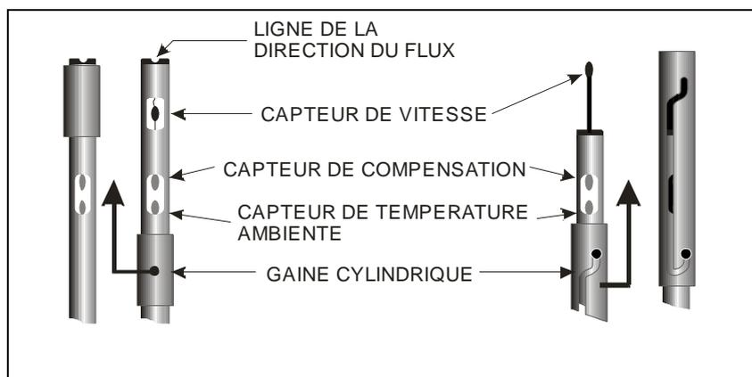
Les sondes AP471 S1, S2 et S3 sont dotées d'une enveloppe cylindrique de protection en mesure de défiler le long d'une glissière. L'enveloppe a deux positions de fin de course qui le bloquent dans la condition de mesure (tout en bas) ou de repos (tout en haut). Pour réduire l'encombrement quand elle n'est pas utilisée, la AP471 S4 et la AP471 S5 sont fournies avec un cylindre de protection à visser sur la tête de la sonde.
