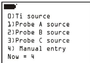
A l'aide de la touche <0> il est possible de sélectionner, comme source pour la compensation, la température interne de l'instrument Ti. Les touches <1/MATH>, <2/LOG> et <3/TIME> permettent de sélectionner la température relevée par la sonde connectée à l'entrée A, B ou C respectivement. Pour entrer manuellement la valeur de température, lorsque aucune sonde n'est
