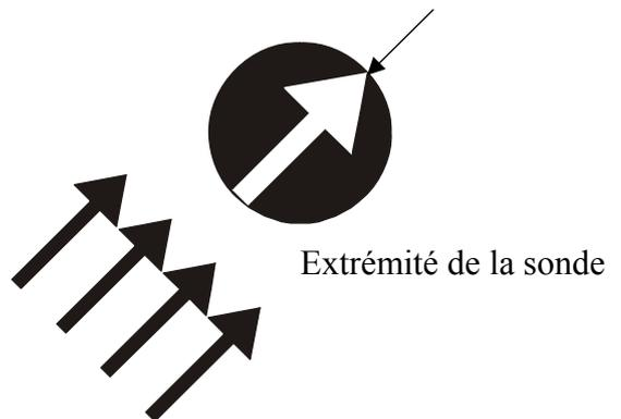
La sonde doit être maintenue perpendiculaire au flux et ne doit pas être inclinée:
