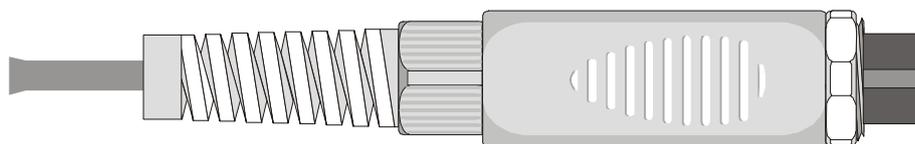
Avant de pouvoir utiliser la sonde, il est nécessaire d'effectuer le calibrage (*consulter à partir de la page 31, les différentes modalités de calibrage*). Si l'on connaît les paramètres de Callendar – Van Dusen de la sonde, ceux-ci peuvent être entrés dans la mémoire et la sonde sera ainsi calibrée (*Voir le paragraphe "View/edit paramtrs" à la page 32*).
