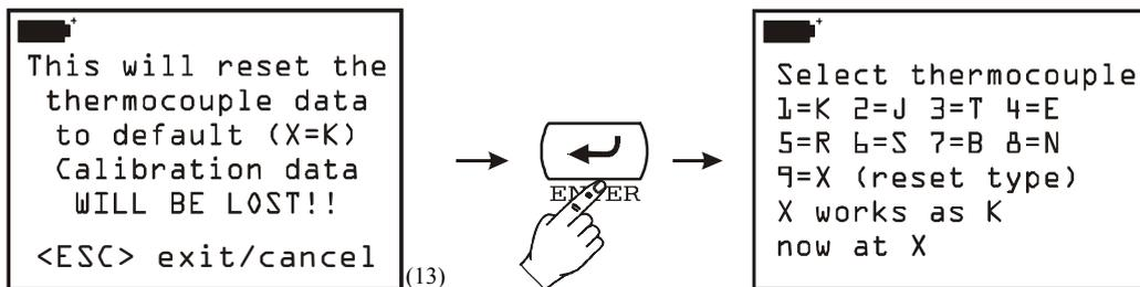
Désormais, il est possible d'insérer le type de thermocouple en appuyant sur la touche numérique correspondante: par exemple, si on désire régler le type de thermocouple J il suffit d'appuyer sur la touche numérique <2/LOG> et à l'affichage successif valider à l'aide de la touche <ENTER>.
