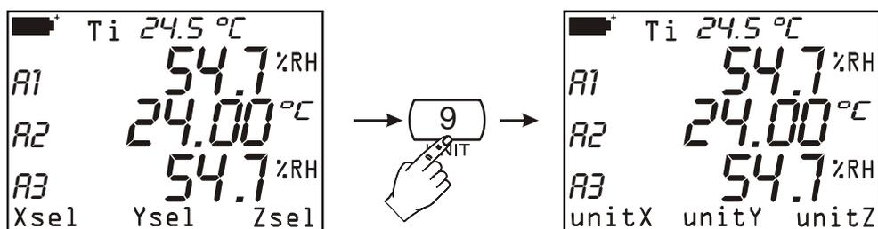
Dans la barre de commandes, les rubriques Xsel, Ysel et Zsel sont remplacées par les rubriques unitX, unitY et unitZ.
