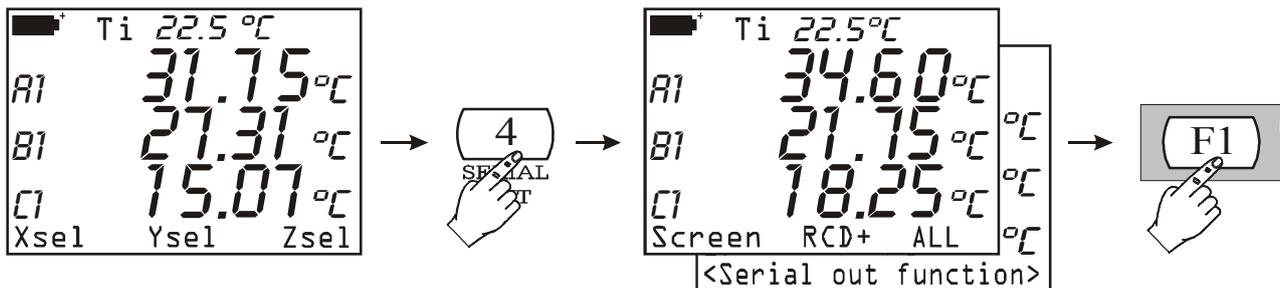
Pour interrompre l'acquisition, l'opérateur doit appuyer sur la touche F1<STOP Printing>:
