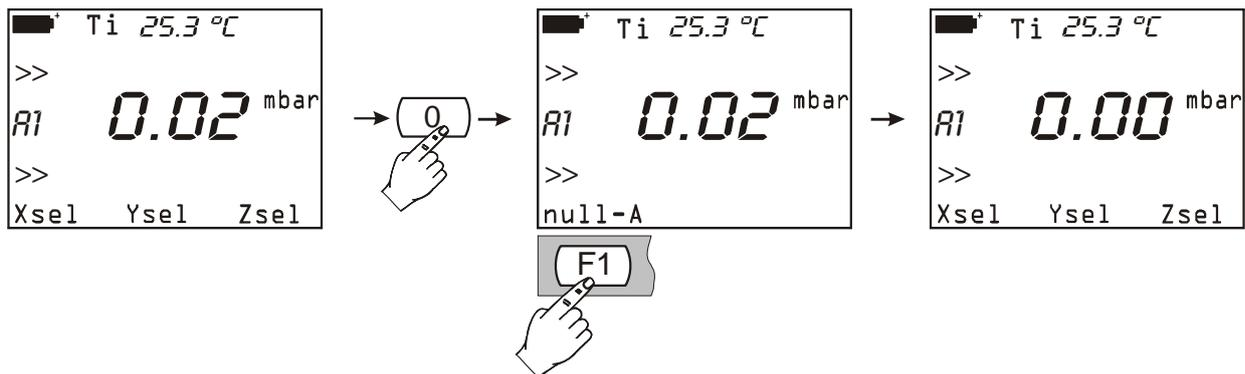
Les messages null\_A, null\_B ou null\_C apparaîtront dans la barre de commandes en fonction de l'entrée à laquelle le module est connecté. Appuyer sur la touche fonction correspondante pour remettre à zéro la pression différentielle: la valeur instantanée sera remise à zéro.
