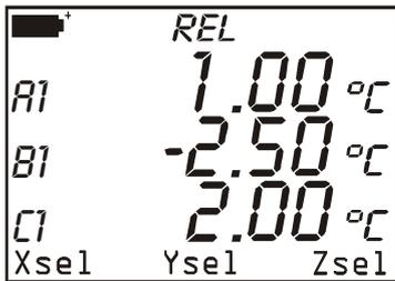
La mesure relative est affichée. Les canaux A et C ont augmenté, le canal B a diminué.
