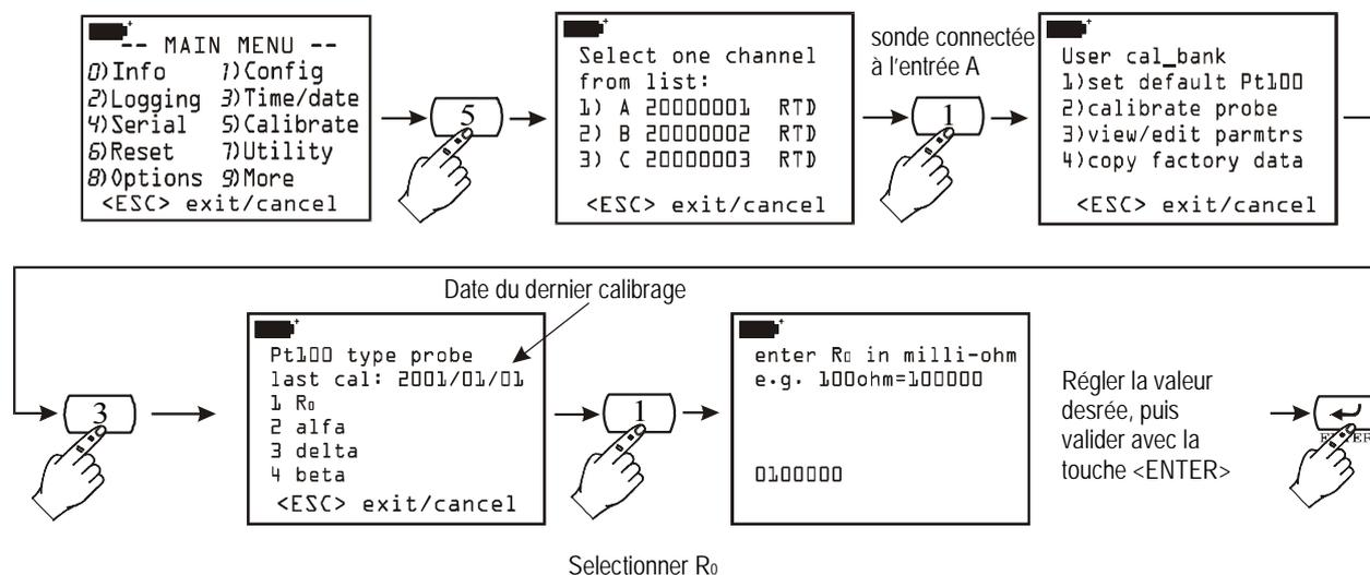
**4) Copy factory data:** cette fonction permet de transférer les données de calibrage d'usine enregistrées dans la sonde. Elle est utile lorsqu'on s'aperçoit que des données de calibrage erronées ont été entrées (par exemple à cause d'un calibrage effectué de manière non correcte) et qu'il est momentanément impossible d'effectuer un nouveau calibrage.
