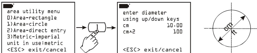
Entrer la valeur du diamètre de la surface circulaire à l'aide des flèches Haut et Bas. **La mesure doit être exprimée en cm ou en pied** selon le système de mesure choisi (métrique ou anglo-saxon). L'instrument propose la mesure de la surface en fonction des unités de mesures sélectionnées. En cas de système anglo-saxon, la mesure correspondante en  $\text{cm}^2$  sera indiquée. Valider les paramètres à l'aide de la touche Enter.
